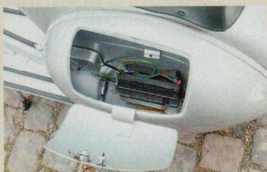
Handschuhfach Fehlanzeige: Die Vespa bietet Stauraum unter der linken „Backe“ in direkter Nachbarschaft der Batterie
