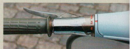
Schalten ohne Kuppeln: Die Halbautomatik der Li macht’s möglich. Die vier Gänge werden per Drehgriff am linken Lenkerende eingelegt
