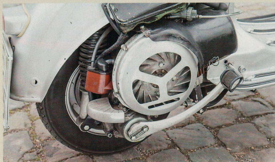
Gewöhnungsbedürftig: Der Motor direkt neben dem Hinterrad spart einen Sekundärtrieb, bringt aber die Gewichtsverteilung durcheinander. Alte Vespa-Hasen nehmen es kaum noch war
